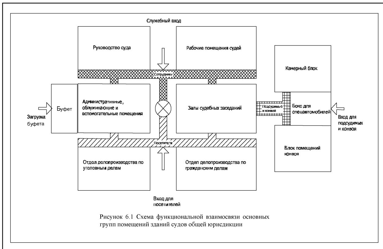
Рисунок 6.1 Схема функциональной взаимосвязи основных групп помещений зданий судов общей юрисдикции
